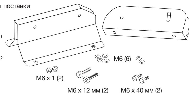
Для установки в стек более трёх модулей требуется специальная система подвеса.
