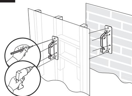
Минимальные требования к установке на деревянные шипы: винт с квадратной головкой 1/4" x 11/2" (M6 x 38 мм)
